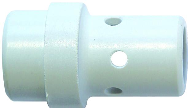
Der Kontaktrohrhalter ist die Aufnahme der Stromdüse. Es gibt zwei Ausführungen, die kompakte Bauweise, bei dieser wird er direkt in die Haltefeder des Brennerhalses geschraubt und übernimmt mithilfe der radialen Bohrungen die Aufgabe der Schutzgasverteilung. Bei Brennern mit einer Belastbarkeit über 200A wird der Kontaktrohrhalter in den separaten Gasverteiler geschraubt.
