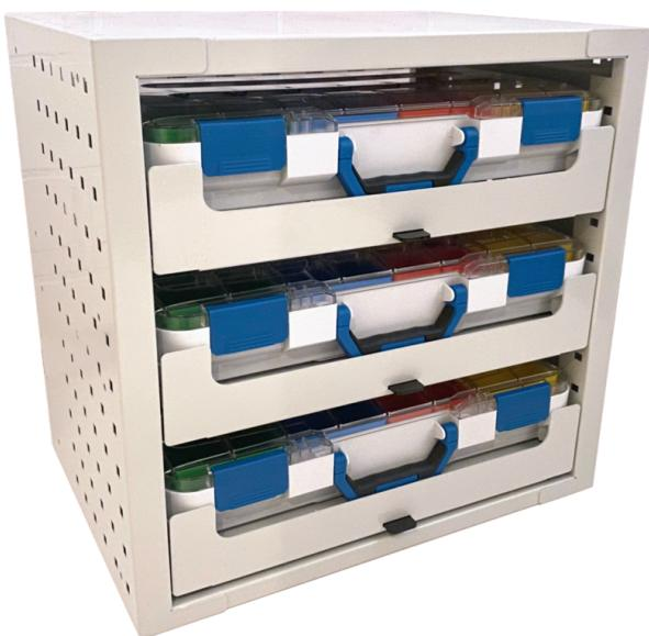
Die leeren Kofferschränke bestehen aus einem thermolackierten Stahlgehäuse. Fast alle Elemente sind gelocht, um Gewicht zu sparen. Die Koffertablare sind durch stabile Führungsschienen geführt und tragen je 50 kg. Die Seitenwände sind mit einer Loch-Rasterung für Haken versehen. inkl 4 Koffer PVC OK 80.23 Höhe Schubladen 80 mm
