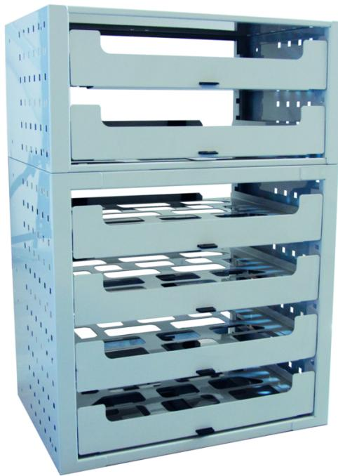
Die leeren Kofferschränke bestehen aus einem thermolackierten Stahlgehäuse. Fast alle Elemente sind gelocht, um Gewicht zu sparen. Die Koffertablare sind durch stabile Führungsschienen geführt und tragen je 50 kg. Die Seitenwände sind mit einer Loch-Rasterung für Haken versehen. Höhe Schubladen 66 mm
