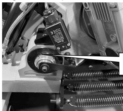
Réglage de l'interrupteur de fin de course
