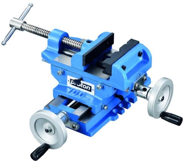
Kreuztisch mit Spannstock für diverse kleinere Bohr- und Fräsarbeiten. Aus massivem Stahlguß, universelle Befestigungsmöglichkeiten, beide Backen mit Prismen und Auflageflächen für einen festen Halt auch bei flachen Werkstücken.
