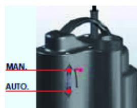
ACHTUNG: Manueller Betrieb: Min. Selbstansaugniveau 15 mm - Min. Absaugniveau 3 mm Automatischer Betrieb: Startniveau 140 mm - Abschaltniveau 30 mm
