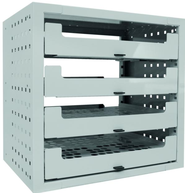
Die leeren Kofferschränke bestehen aus einem thermolackierten Stahlgehäuse. Fast alle Elemente sind gelocht, um Gewicht zu sparen. Die Koffertabläre sind durch stabile Führungsschienen geführt und tragen je 50 kg. Die Seitenwände sind mit einer Loch-Rasterung für Haken versehen. Höhe Koffer 66 mm
