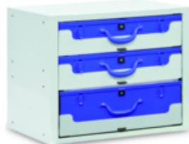
Die leeren Kofferschränke bestehen aus einem thermolackierten Stahlgehäuse. Fast alle Elemente sind gelocht, um Gewicht zu sparen. Die Koffertabläre sind durch stabile Führungsschienen geführt und tragen je 50 kg. Die Seitenwände sind mit einer Loch-Rasterung für Haken versehen. Höhe Koffer 66 und 173 mm
