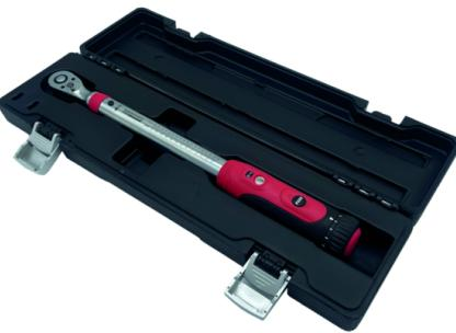
FÜR DEN TÄGLICHEN EINSATZ IN DER WERKSTATT UND AUF MONTAGE Die passgenauen Platzhalter bieten jedem Werkzeug seinen Platz und einen sicheren Halt. Eine einfache Reinigung bei Verschmutzung ist garantiert Links-rechts umstellbar, 0,1 Nm Feinskala Besteckend hohe Qualität der Verarbeitung Genauigkeit +/- 4%, nach ISO 6789-1:2017 Drehmomentschlüssel mit hoher Qualität und Verarbeitung.
