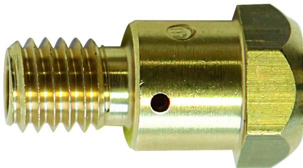
Der Kontaktrohrhalter ist die Aufnahme der Stromdüse. Es gibt zwei Ausführungen, die kompakte Bauweise, bei dieser wird er direkt in die Haltefeder des Brennerhalses geschraubt und übernimmt mithilfe der radialen Bohrungen die Aufgabe der Schutzgasverteilung. Bei Brennern mit einer Belastbarkeit über 200A wird der Kontaktrohrhalter in den separaten Gasverteiler geschraubt.
