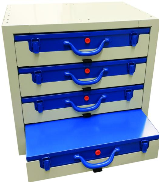
Die leeren Kofferschränke bestehen aus einem thermolackierten Stahlgehäuse. Fast alle Elemente sind gelocht, um Gewicht zu sparen. Die Koffertablare sind durch stabile Führungsschienen geführt und tragen je 50 kg. Die Seitenwände sind mit einer Loch-Rasterung für Haken versehen. inkl 4 Koffer OK 66.23 Höhe Koffer 66 mm
