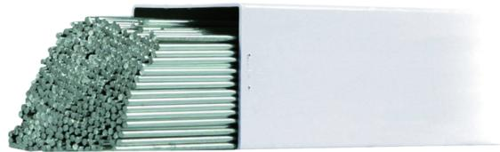
WIG - Zusatzstoff zum Schweißen von Aluminium-Magnesium-Legierungen. Seine hervorragende mechanische Eigenschaften verleihen ihm eine hohe Zugfestigkeit (250 MPa). Es wird wegen seiner extremen Beständigkeit gegen salzhaltige Umgebung für den Schiffbau empfohlen.
