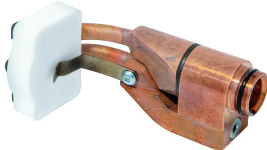
Die Induktoren S20B1 & S180B1 sind Induktoren mit austauschbaren Ferriten. Mit ihnen kann man kleine Teile erhitzen, vor allem bei der Wartung von Fahrzeugen. Aufgrund ihrer geringen Grösse bieten sie die Möglichkeit, schwierige Stellen mit einer sehr lokalisierten Erwärmung zu erreichen.
